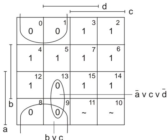
**Рис. 20. Пример минимизации по карте Карно ПФ  $f(abcd) = 2, 3, 4, 5, 6, 7, 12, 14, 15$  [0, 1, 8, 9, 13] в классе КНФ**
