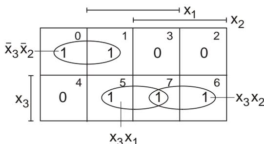
**Рис. 15.** Пример минимизации по карте Карно ПФ  $f(x_3 x_2 x_1) = 0, 1, 5, 6, 7 [2, 3, 4]$
