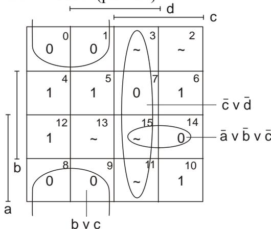
Рис. 23. Пример минимизации по карте Карно ПФ  $f(abcd) = 4, 5, 6, 10, 12$  [0, 1, 7, 8, 9, 14] в классе КНФ
