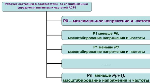
Рисунок 10 – Масштабирование рабочих состояний процессора
