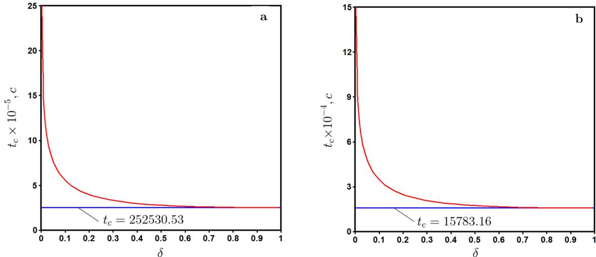
Рис. 2. Зависимость характеристического времени от отношения радиусов цилиндров  $\delta$  (красная линия) для рассмотренного примера при (а)  $\Delta T = 1$  К и (б)  $\Delta T = 4$  К. Синей линией показано значение времени для случая плоской колонны
