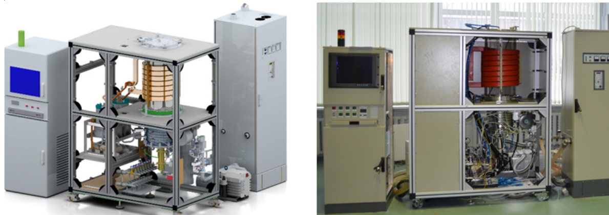
Рисунок 1 – Модель и реальное исполнение установки для выращивания монокристаллов карбида кремния и отжига эпитаксиальных пластин
