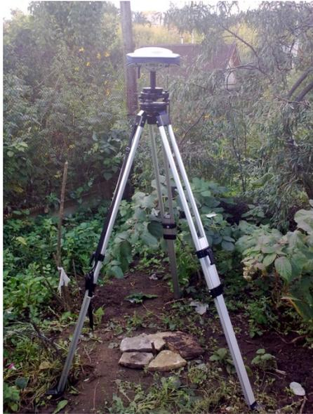
Рис. 5. Базовая станция
