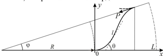
**Рис. 1. Изменение формы упругого элемента при трансформации антенны**
