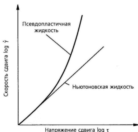
Рисунок 3 – Свойства полимеров в зависимости от напряжения сдвига
