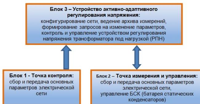
Рисунок 1 – Структурная схема взаимодействия и функционал блоков системы
