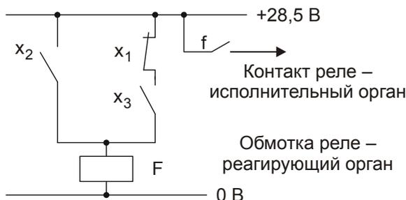
Рис. 52. Релейно-контактная схема реализации логической функции  $x_2 \vee \bar{x}_1 x_3$
