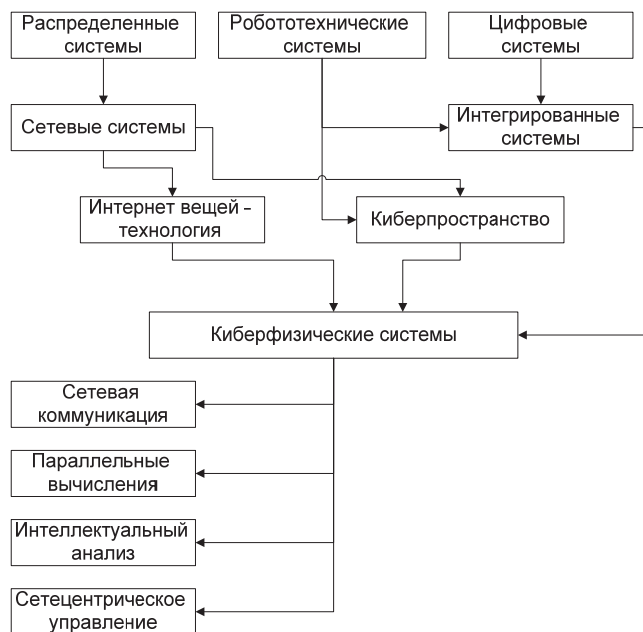
Рис. 1. Схема эволюции киберфизической системы и ее функциональные возможности
