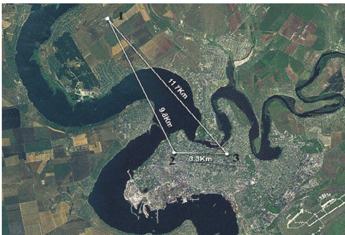
Рисунок 9 – Схема взаимного расположения точек измерения скорости ветра
