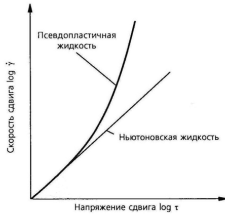
Рисунок 3 – Свойства полимеров в зависимости от напряжения сдвига
